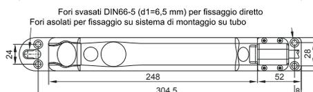
**Sensore di livello a ultrasuoni in aria, Tipo OCL**
