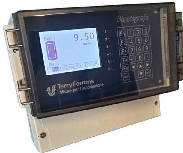
È lo strumento ideale per la gestione in automatico delle vasche di sedimentazione.
