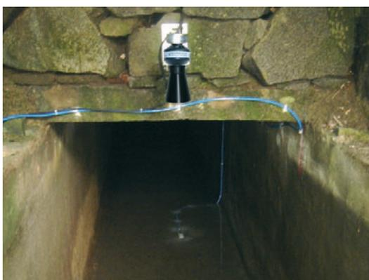
AquaRanger VHQ è lo strumento a ultrasuoni più preciso per la misura di portata in canali aperti attualmente esistente. Il sistema si basa sull'utilizzo di un'elettronica, di uno o due trasduttori a ultrasuoni / radar posti al di sopra del liquido da misurare e da un misuratore di velocità. La portata in un canale è funzione dell'area bagnata, che dipende dalla forma del canale, dall'altezza del liquido e dalla velocità.
