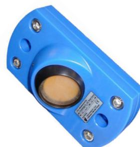
La tecnica del tempo di transito utilizza una coppia di trasduttori per ogni corda fonica, e ogni trasduttore invia e riceve dei segnali ad ultrasuoni codificati attraverso il fluido. Quando il fluido scorre, il segnale del tempo di transito nella direzione di valle è minore di quello nella direzione di monte: la velocità con cui si muove il liquido è data dalla differenza tra questi due tempi di volo.
